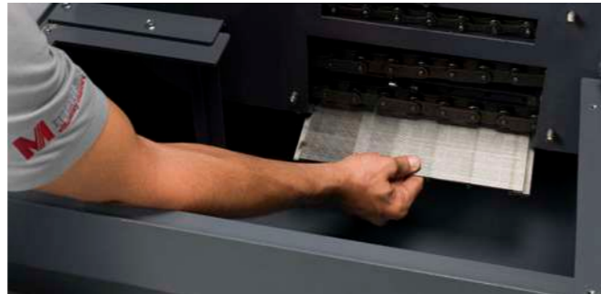
// Clevere Option: Scharnierbandförderer im Arbeitsraum und Kratzbandförderer für Vorabscheidung (500–300 µm) mit Späneaustrag und Abreinigung über Spaltsieb im Zusatztank. // Intelligent option: hinge belt conveyor in the work space and scraper conveyor for 500–300 µm pre-separation with chip removal and cleaning through a slotted screen in the secondary tank.
