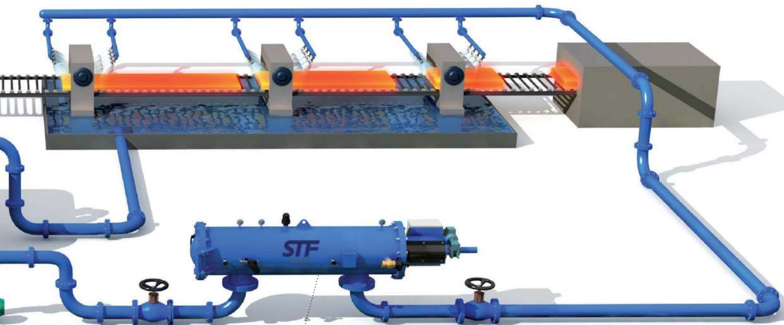
FMA-2000. Nozzle protection at rolling cart Protección boquillas carro de laminación Protection des buses du charriot de laminage
