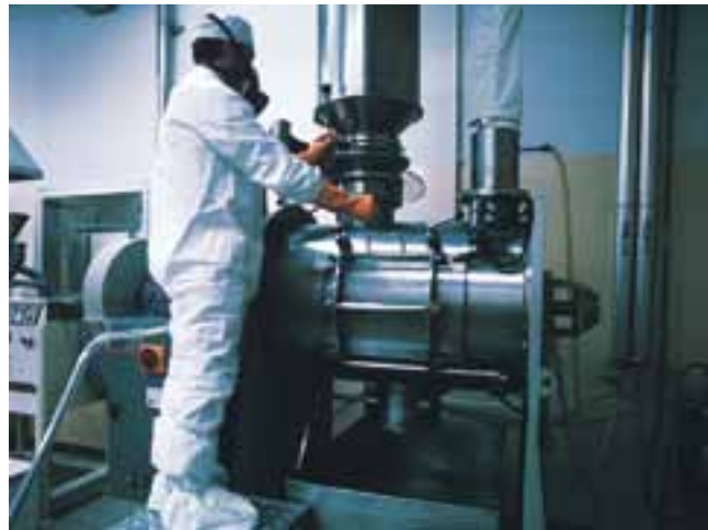
Intercettazione on/off a leva manuale: caricamento mescolatore orizzontale. Product flow control with an on/off hand lever: loading of a horizontal blender at SCHERING S.P.A. Segrate, Milano
