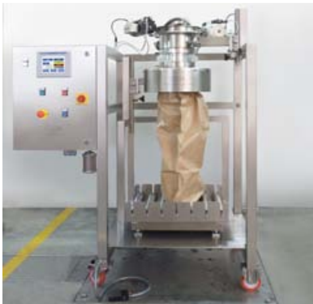
Sistema di dosaggio ad anello gonfiabile / Inflatable ring dosing system
