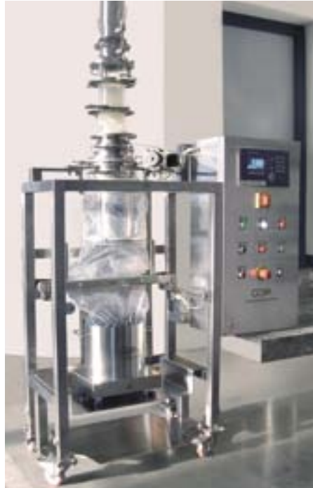
Sistema dosaggio liner continuo, scarico e dosaggio tappi da autoclave Continuous liner dosing system discharge and dosing of caps from autoclave
