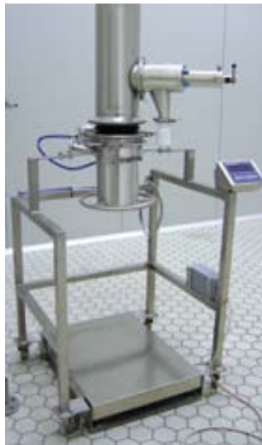
Sistema dosaggio liner continuo, scarico e dosaggio da essiccatore Continuous liner dosing system discharge and dosing from a dryer
