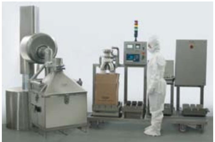
Sistema di dosaggio capsule e compresse con STERI LIFT Dosing system for capsules and tablets whit STERI LIFT
