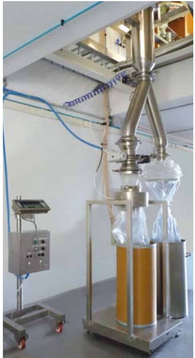
Scarico prodotto da TIP "0" SYSTEM e dosaggio Product discharge from TIP "0" SYSTEM and dosing
