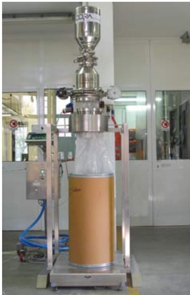
Sistema di dosaggio ad anello gonfiabile Inflatable ring dosing system
