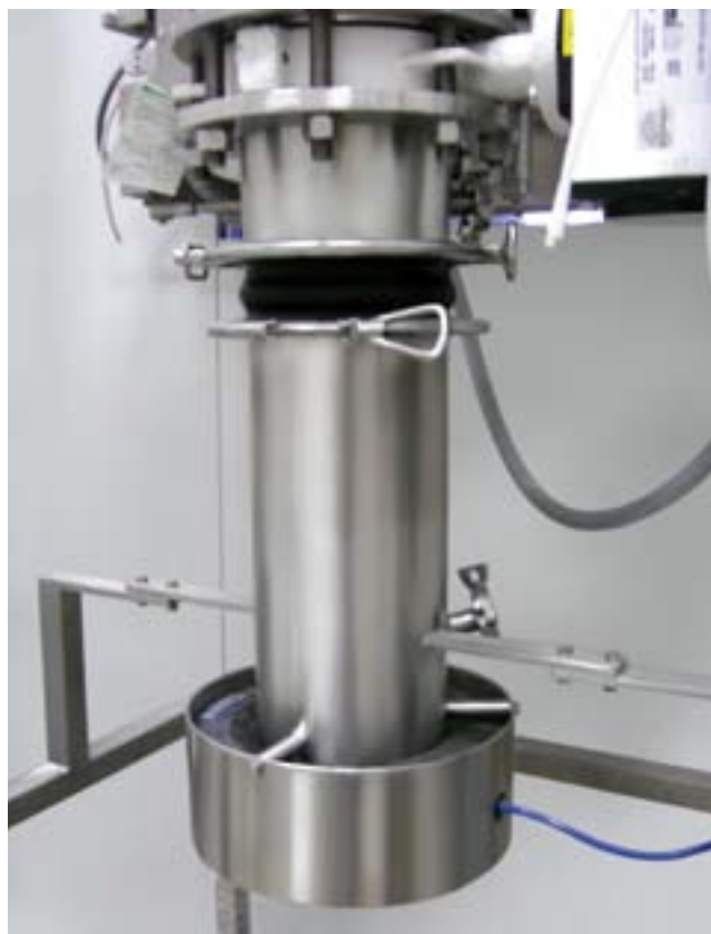
Dettaglio sistema di dosaggio ad anello gonfiabile Detail of inflatable ring dosing system
