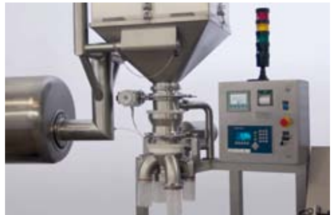
Dettaglio sistema di dosaggio capsule e compresse Detail of dosing system for capsules and tablets
