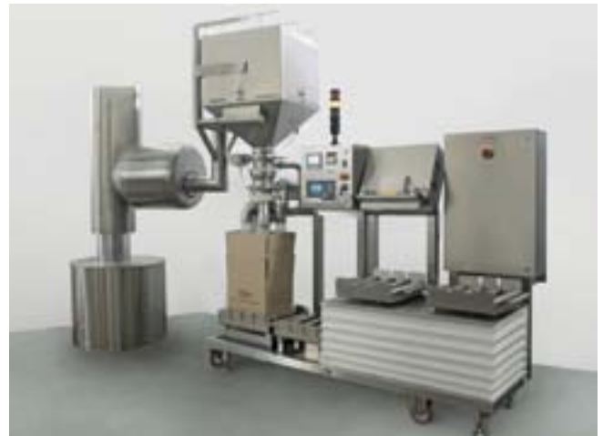
Sistema di dosaggio capsule e compresse Dosing system for capsules and tablets
